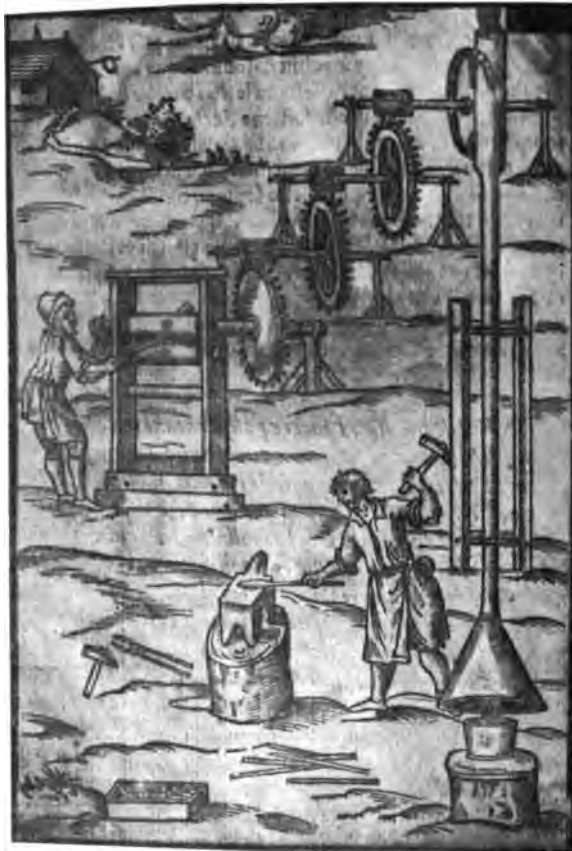
Abb. 98. Entwurf eines Münzwalzwerks mit Warmluftturbine. Branca 1629. (Das Turbinenrad, liegt oben im Schornstein des Schmiedefeuers.)
