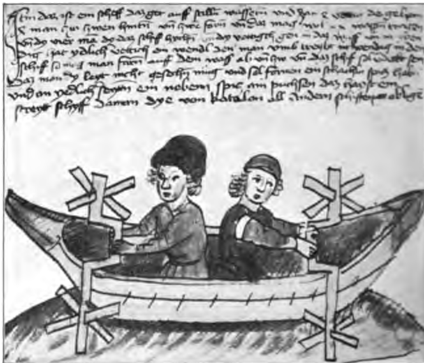
Abb. 157. Kriegsbarke mit Schaufelrädern. Entwurf von etwa 1430.
