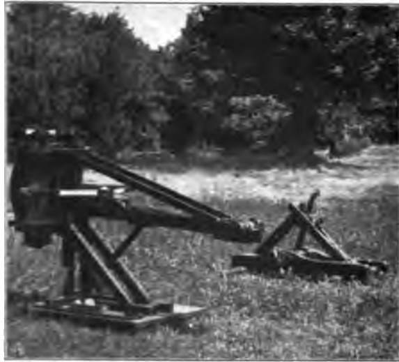
Abb. 32. Rekonstruktion griechisch-römischer Geschütze auf der Saalburg. Rechts: Schleuder (Wurfweite 140 m für eine Bleikugel von 1 Pfund). Links: Steilbahngeschütz (Wurfweite 300 m für eine Bleikugel von 1 Pfund).
