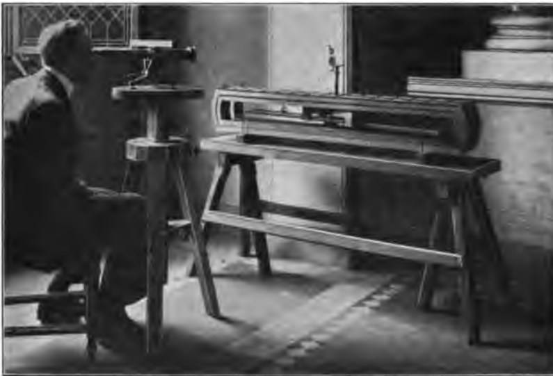
Abb. 229. Elektrisch-magnetischer Telegraph von Gauß.
