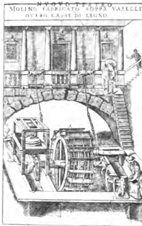
Abb. 74. Schiffsmühle zum Mahlen und Stampfen, 1607.
