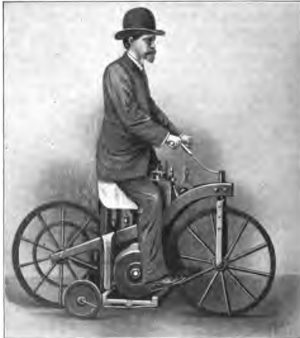
Abb. 192. Das Daimlersche Kraftfahrzeug von 1886.
