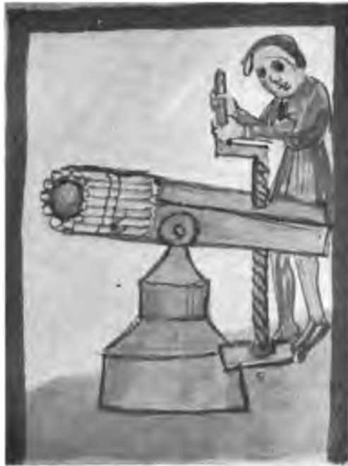
Abb. 44. Revolvergeschütz nach dem Artilleriebuch, um 1380.
