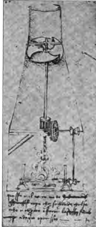
Abb. 97. Bratenwender mit Warmluftbetrieb von Leonardo da Vinci.
