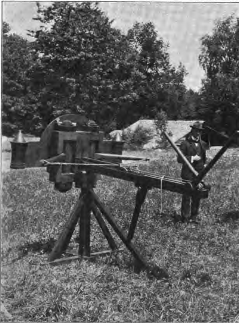
Abb. 33. Rekonstruktion eines griechisch-römischen Flachbahngeschützes für Pfeile auf der Saalburg (Wurfweite 369,5 m für 88 cm lange Pfeile. Auf diese Entfernung erreicht der Pfeil eine solche Durchschlagskraft, daß er einen eisenbeschlagenen, 3 cm starken Schild zur Hälfte seiner Länge — also auf 44 cm — durchdringt und den dahinterstehenden Krieger außer Gefecht setzen würde).
